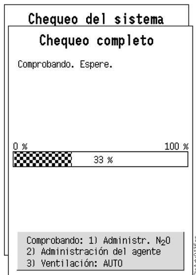
**Figura 72 El menú Chequeo completo automático y de ventilación AUTO**
